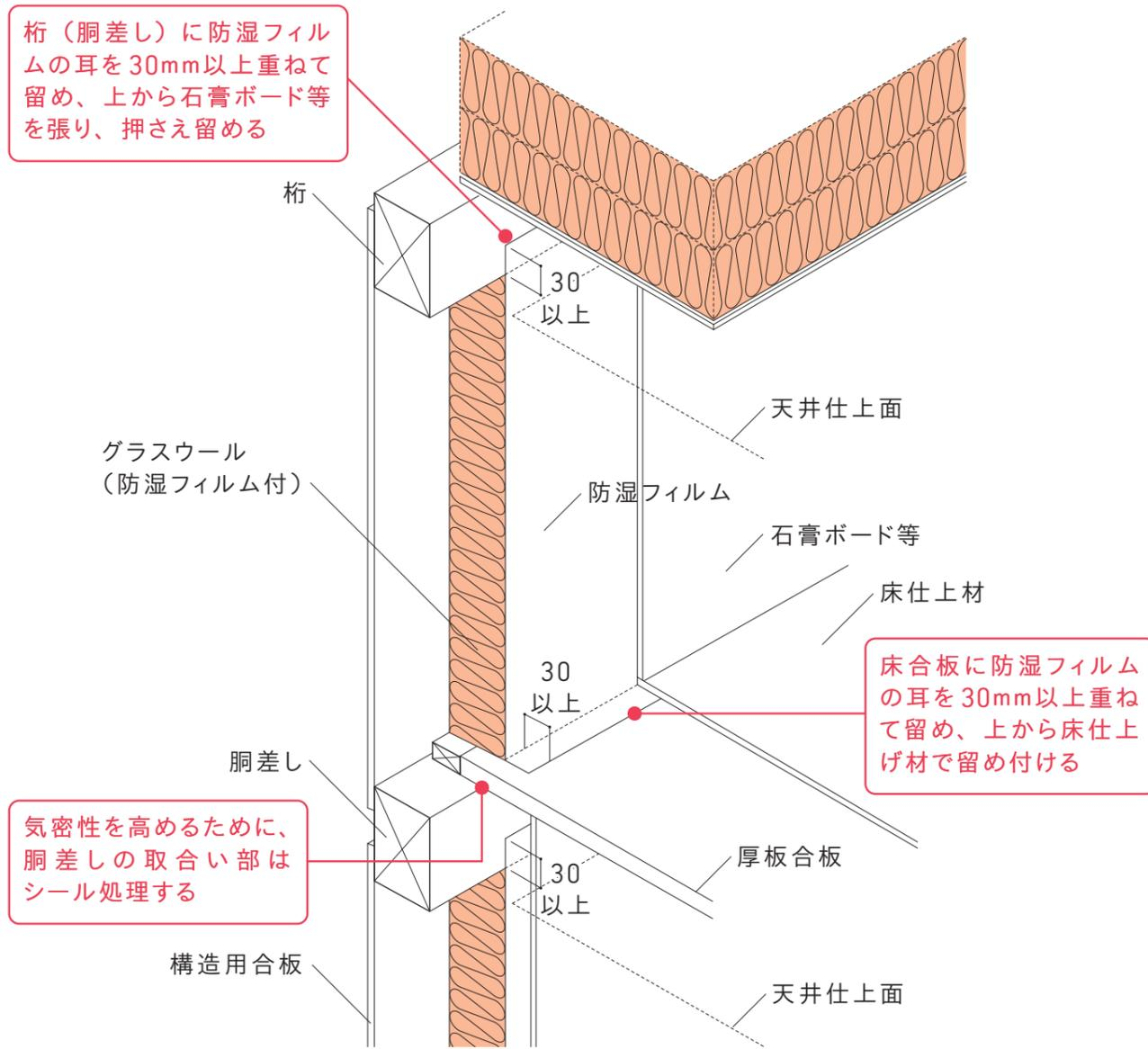
・2階の床合板と胴差しの取合い部に隙間があると、室内の湿気が壁内に入り込んだり、外気が室内に入り込んだりするため、1階の天井を施工する前にコーキング材や発泡ウレタンでシール処理する。
