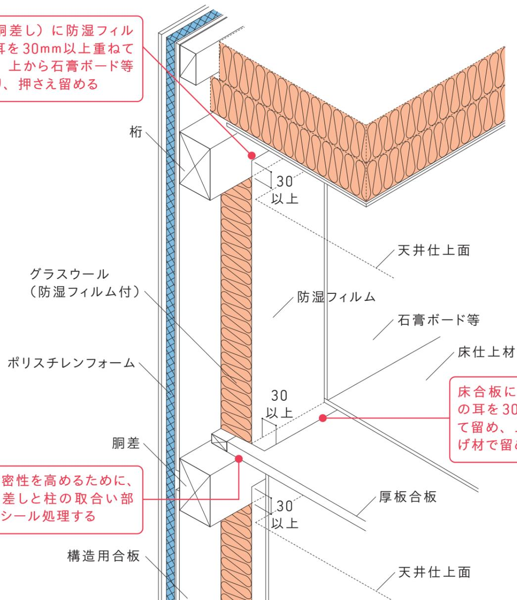
床合板に防湿フィルムの耳を30mm以上重ねて留め、上から床仕上げ材で留め付ける
